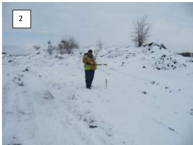
1 – проведение гамма-съемки, 2 – измерение МЭД в контрольной точке.
